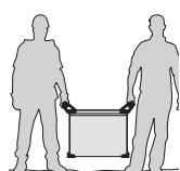
Mai sollevare una bombola di gas e la fonte di corrente di saldatura nello stesso momento. Loro norme di trasporto sono distinte. È preferibile togliere la bobina prima di ogni sollevamento o trasporto del dispositivo di corrente di saldatura.
