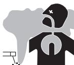
I fumi, gas e polveri emesse dalla saldatura sono pericolosi per la salute. È necessario prevedere una ventilazione sufficiente e a volte è necessario un apporto d'aria. Una maschera ad aria fresca potrebbe essere una soluzione in caso di aerazione insufficiente. Verificare che l'aspirazione sia efficace controllandola in relazione alle norme di sicurezza.
