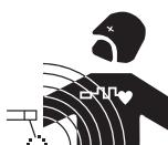
Elektrische stroom die door een geleider gaat veroorzaakt elektrische en magnetische velden. De lasstroom wekt een elektromagnetisch veld op rondom de laszone en het lasmateriaal.
