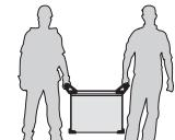
Никогда не поднимайте газовый баллон и источник тока одновременно. Их транспортные нормы различаются. Желательно снять бобину проволоки перед тем, как поднимать или переносить источник сварочного тока.
