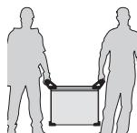
Halten Sie sich unbedingt an die unterschiedlichen Transportrichtlinien für Schweißgeräte und Gasflaschen. Diese haben verschiedene Beförderungsnormen. Die Drahtspule sollte vor dem Heben und Transport des Schweißgerätes entfernt werden.
