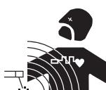
Электрический ток, проходящий через любой проводник, вызывает локализованные электромагнитные поля (EMF). Сварочный ток вызывает электромагнитное поле вокруг сварочной цепи и сварочного оборудования.
