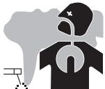
Выделяемые при резке дым, газ и пыль опасны для здоровья. Вентиляция должна быть достаточной, и может потребоваться дополнительная подача воздуха. При недостаточной вентиляции можно воспользоваться маской сварщика-респиратором. Проверьте, чтобы всасывание воздуха было эффективным в соответствии с нормами безопасности.
