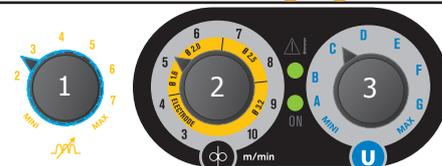
1. Permet d'ajuster manuellement la **dynamique d'arc (MIG-MAG)**
