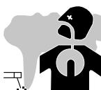
Rook, gassen en stof uitgestoten tijdens het snijden zijn gevaarlijk voor de gezondheid. Zorg voor voldoende ventilatie, soms is toevoer van verse lucht tijdens het lassen noodzakelijk. Een lashelm met verse luchtaanvoer kan een oplossing zijn als er onvoldoende ventilatie is.
