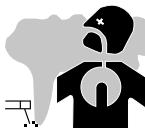
El humo, el gas y el polvo que se emite durante el corte son peligrosos para la salud. Hay que prever una ventilación suficiente y en ocasiones puede ser necesario un aporte de aire. Una máscara de aire puede ser una solución en caso de aireación insuficiente. Compruebe que la aspiración es eficaz controlándola conforme a las normas de seguridad.
