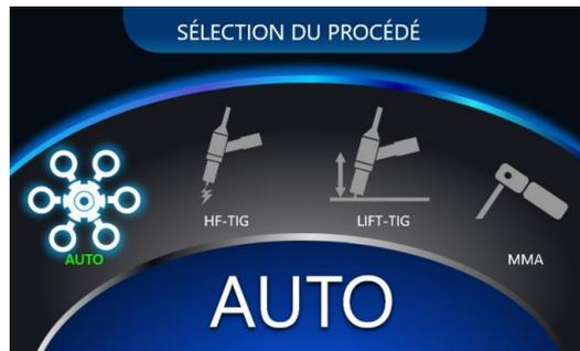
TIG AUTO - paramètre synergique. L'utilisateur renseigne ses paramètres de soudage tels que le matériau de la pièce et son épaisseur. Le reste des paramètres sera automatiquement ajusté par le poste d'après sa base de données.
